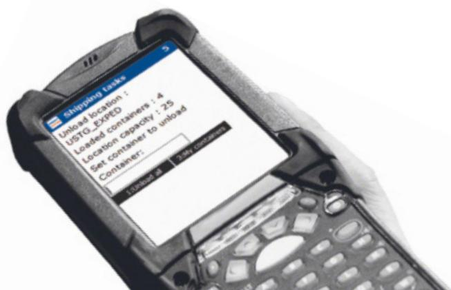
L'Easy WMS de Mecalux communique avec les opérateurs via les terminaux de radiofréquence, en leur indiquant la quantité de stock qu'ils doivent déposer dans chaque conteneur
