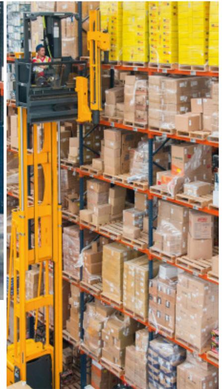
Chaque bloc de rayonnage mesure 10,25 m de haut, 100 m de long et dispose de sept niveaux de stockage
