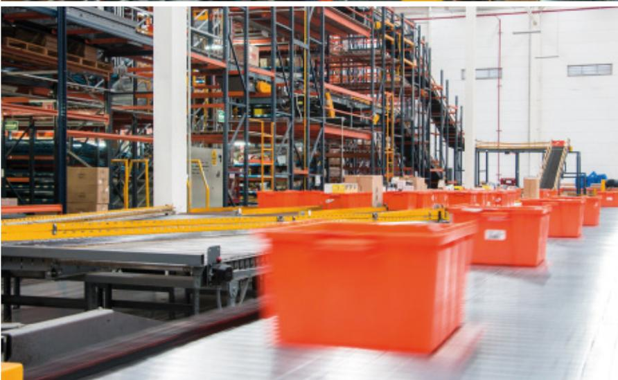
Apymrsa est une entreprise spécialisée dans la distribution de pièces automobiles. Elle possède dans la ville de Guadalajara (Mexique) un grand entrepôt principalement destiné aux opérations de picking. L'installation, fournie par Mecalux, est composée de deux tours de préparation de commandes intégrées à un circuit de convoyeurs, de rayonnages et d'une trieuse.
