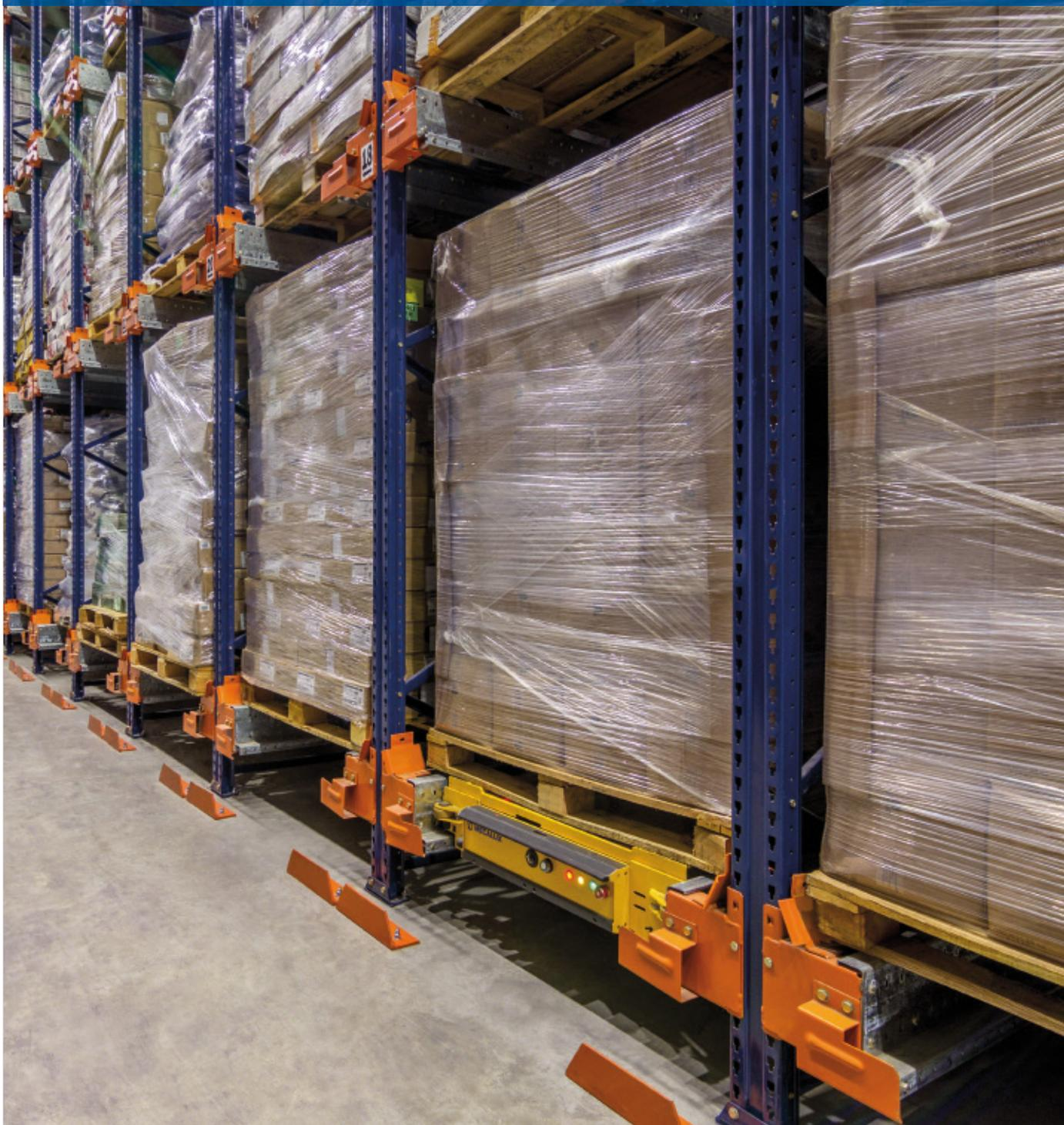
L'opérateur logistique argentin Frío Dock a inauguré un nouvel entrepôt à Tortuguitas (Buenos Aires) afin de faire face à l'augmentation de la production de ses clients. Mecalux l'a équipé de deux blocs de rayonnages dotés du système Pallet Shuttle semi-automatique, qui offrent une capacité de stockage totale de 2 280 palettes.
