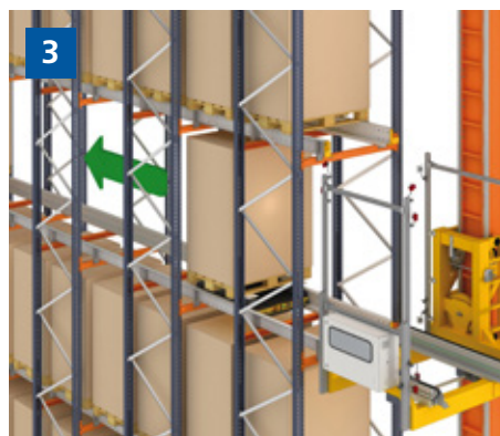
3. La navette automatique incline légèrement la charge et s'introduit dans le canal de stockage. Elle se déplace à côté de la palette jusqu'au premier emplacement libre et, une fois arrivée, elle descend la palette et l'appuie contre la partie supérieure du rail.
