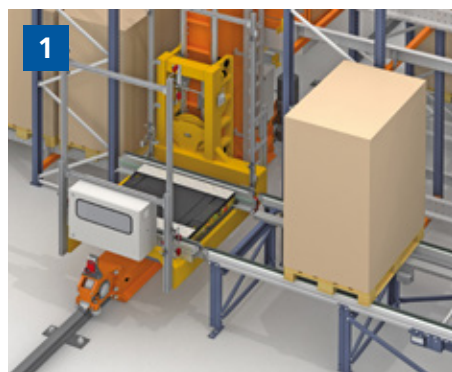
1. Le Pallet Shuttle dans la nacelle du transstockeur attend l'arrivée de la palette provenant du poste d'inspection.
