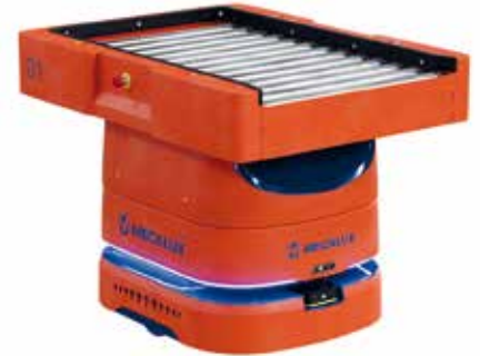
AMR 100 Box avec convoyeur à chargement séquentiel par l'avant de deux bacs de 600 mm de large.
