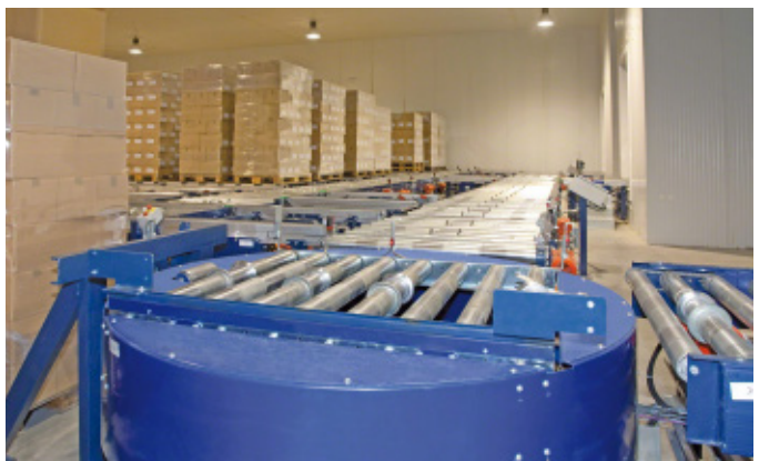
Convoyeur mixte à rouleaux et à chaînes
